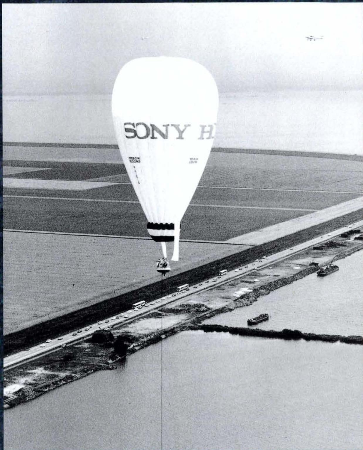
La rozière est formée par la combinaison d'un ballon à hélium et d'un ballon à air chaud. Un petit brûleur de propane est utilisé pour maintenir la température de l'hélium plus ou moins au même niveau en l'absence du chauffage solaire. Ceci permet d'augmenter largement la durée de vol sans dépenser de l'hélium ni larguer de poids.
